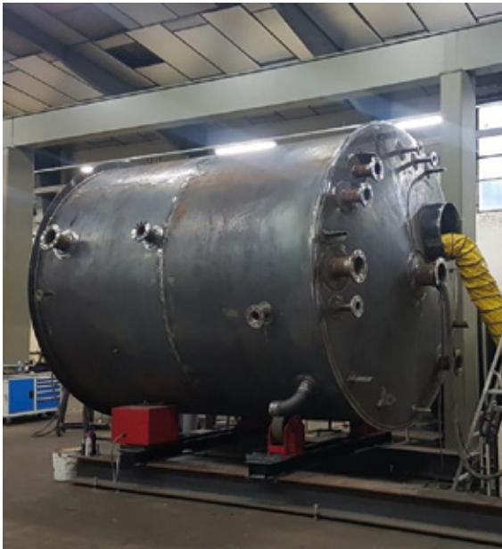
Cuve de stockage sous CODRES Ø 3 ml
